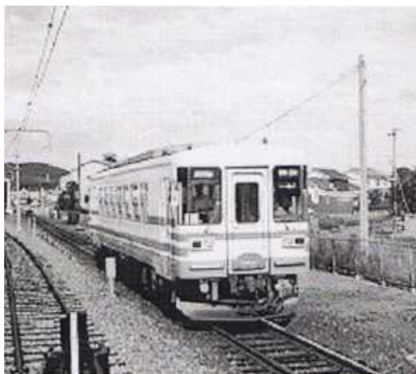
図 2-2-9 三木鉄道の車両ミキ 300 形 (北条鉄道の新型車両・フラワ 2000 形と共通設計)
