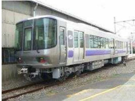
図 3-2-4 燃料電池試験車両クワ R291-1
