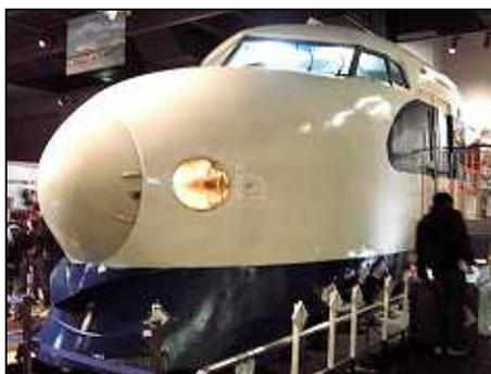
図 2-2-1 東海道新幹線開業時から使用された 0 系新幹線車両
