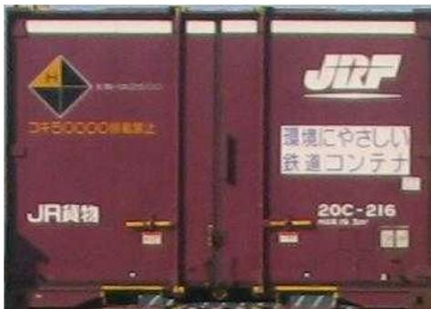
写真は 12ft コンテナの一種で背高コンテナである。このコンテナは車高が高いコキ 50000 系車両には積載できない旨が記されている。
