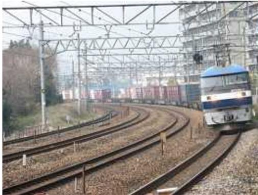
図 2-1-3 スーパーライナーの流れをくむ高速貨物列車
