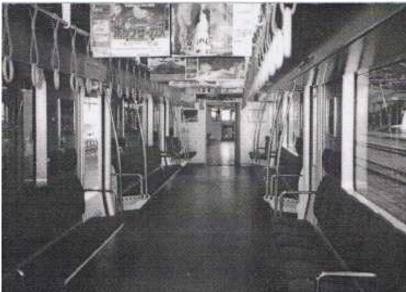
図 2-2-15 ロングシート構造が踏襲された 815 系車両の車内
