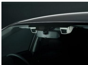
図表 7 : SUBARU の運転支援システム EyeSight は すでに実用化された技術の成果の一つである
