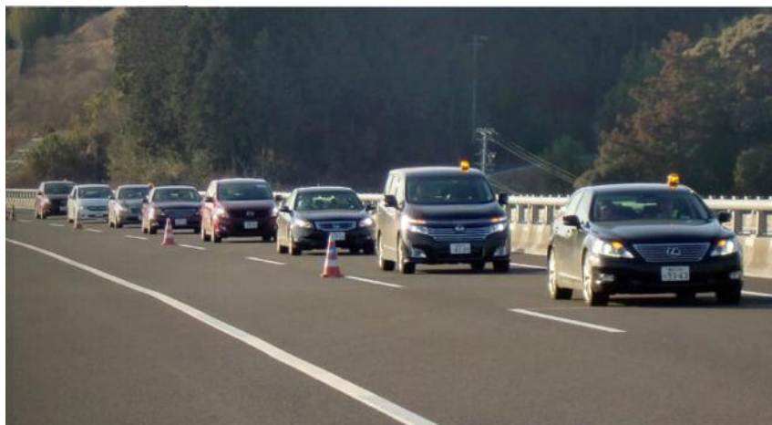
図表 8 : 開通前の新東名高速道路で行われた ACC の試験
