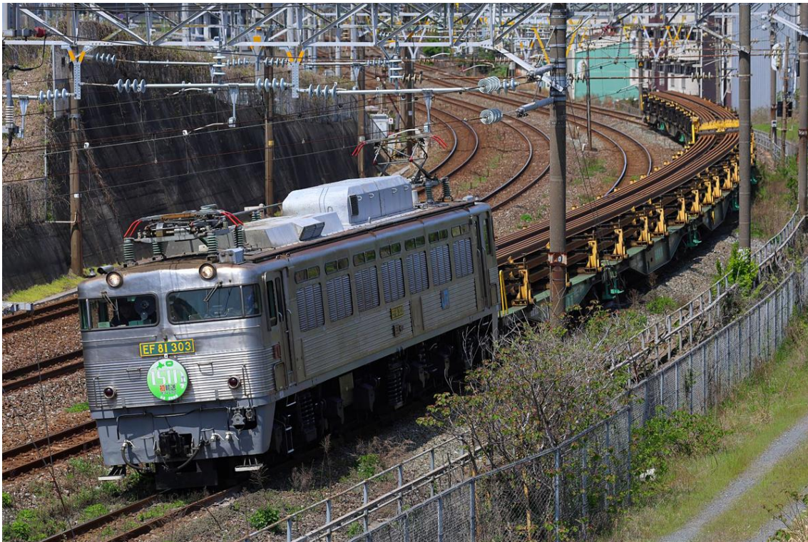
北海道新幹線向け 150m レール初輸送の様子 （写真：独立行政法人鉄道建設・運輸整備支援機構）
